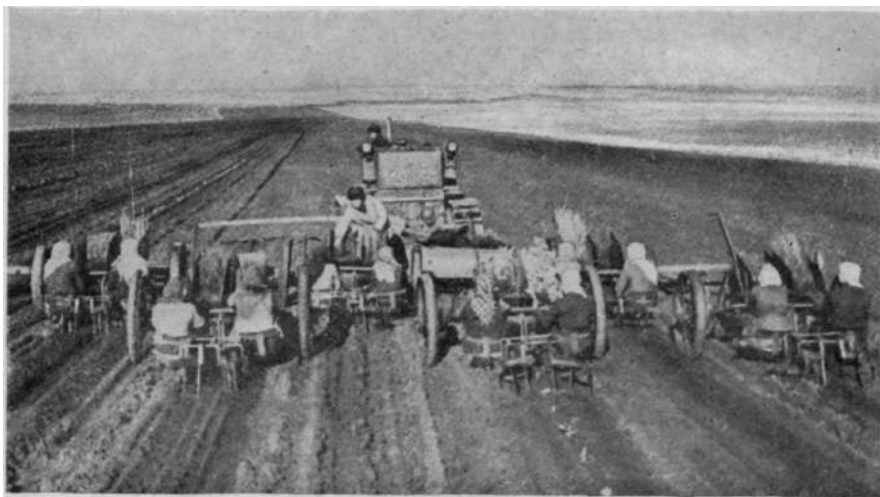
На трассе Государственной полесоащитной лесной полосы Чапаевск — Владимировна (Куйбышевская область). НА СНИМКЕ: сцеп из шести лесопосадочных машин Безенчукской лесозащитной станции на осенней посадке.
